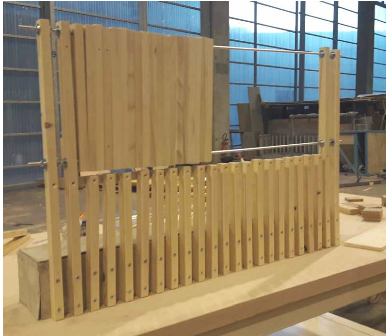
Prototype au 1/5ème du bardage bois en façade
